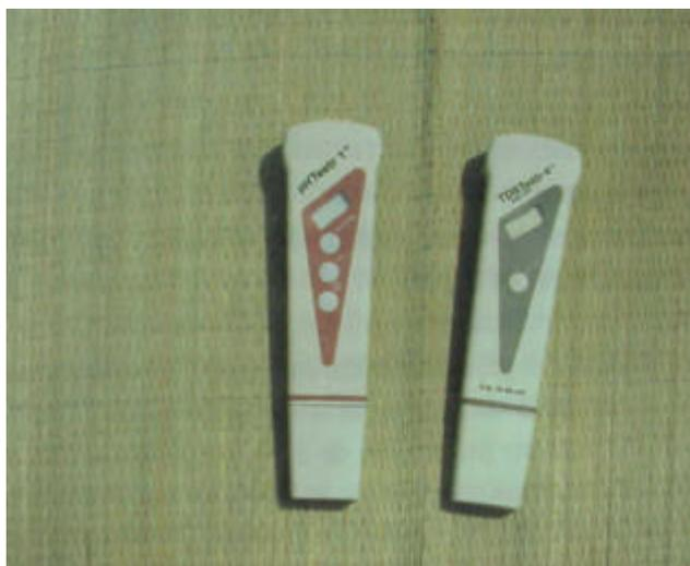
Fotografía 22: Medidores portátiles de pH (a la izquierda de la fotografía) y conductividad eléctrica (a la derecha)
