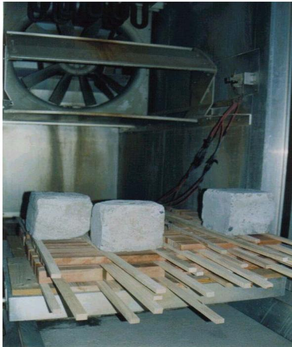
Los ensayos de propiedades físicas se realizan en el Laboratorio de Química de la Madera de la Universidad de Talca, campus Lircay, Talca. En este laboratorio se procede a pesar, secar hasta peso anhidro y medir dimensión de las probetas.
