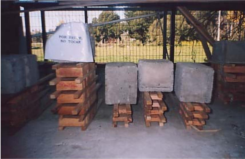
Foto 2. Madera encastillada en la cámara de secado experimental.
