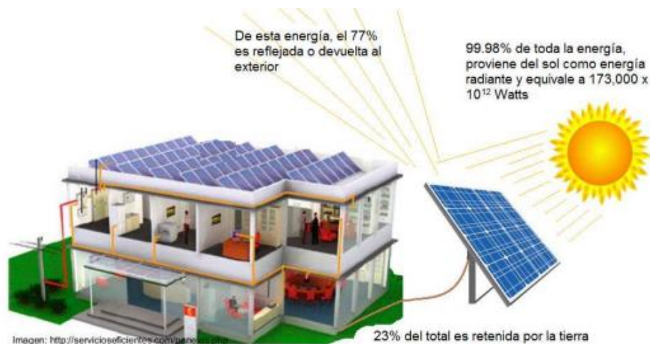
Figura 2.9: Funcionamiento de paneles solares domiciliarios. Fuente: (Arancibia, 2016)
