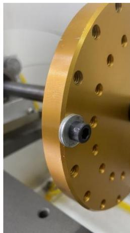
*Fig. 6.4.2 Disco de inercia con masa de 8 gr a 72,5 mm del centro.*
