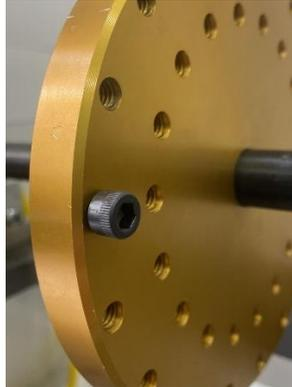
Fig. 15 Montaje de masa (4gr). Fuente: Propia
