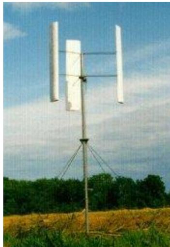
Fig. 5 Aerogenerador Giromill
