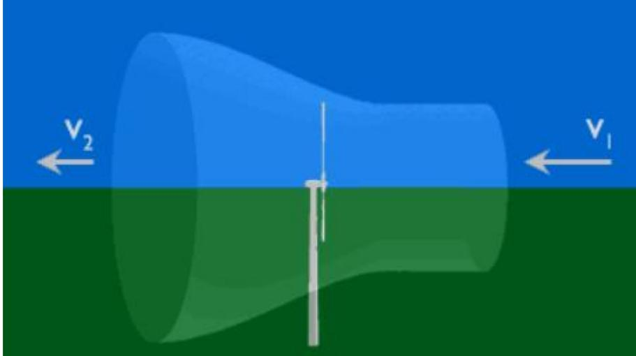
Fig. 17 Tubo de corriente de aire (Fuente: ZUÑIGA, 2017)
