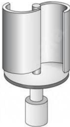
Fig. 6 Rotor de Savonius tradicional
