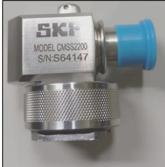
Figura 3.2: Acelerómetro piezoeléctrico. Fuente: Elaboración propia
