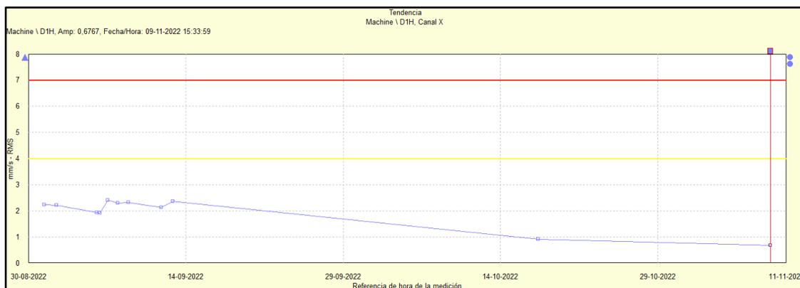
Gráfico 3.3: Gráfico de tendencia de velocidad mm/s-RMS descanso lado acoplamiento D1 .
