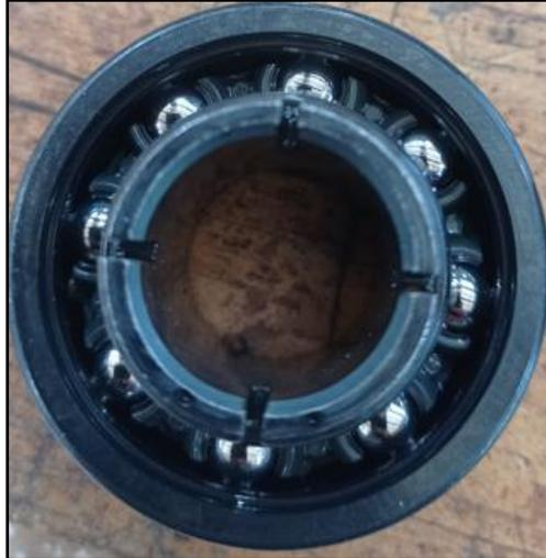
Figura 3.4: Rodamiento abierto sin sello de contaminación. Fuente: elaboración propia
