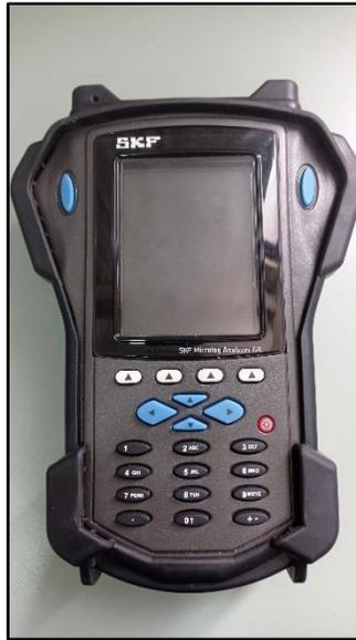
Figura 3.1: Dispositivo de adquisición de datos, microlog analyser. Fuente: Elaboración propia
