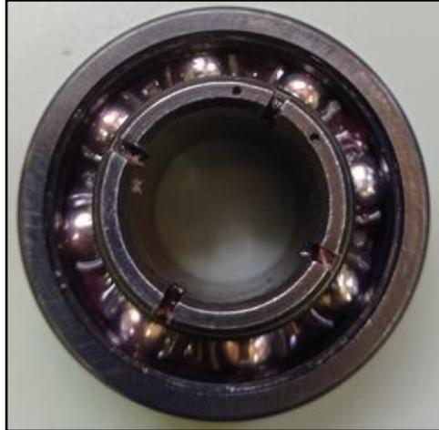
Figura 3.16: Rodamiento con los elementos rodantes a la vista. Fuente: Elaboración propia
