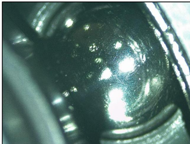
Figura 3.17: Elemento rodante sin daño superficial. Fuente: Elaboración propia
