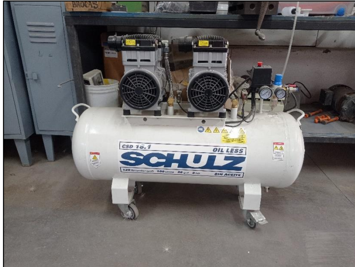
Ilustración 5.4: Equipo auxiliar - Compresor de aire sin aceite
