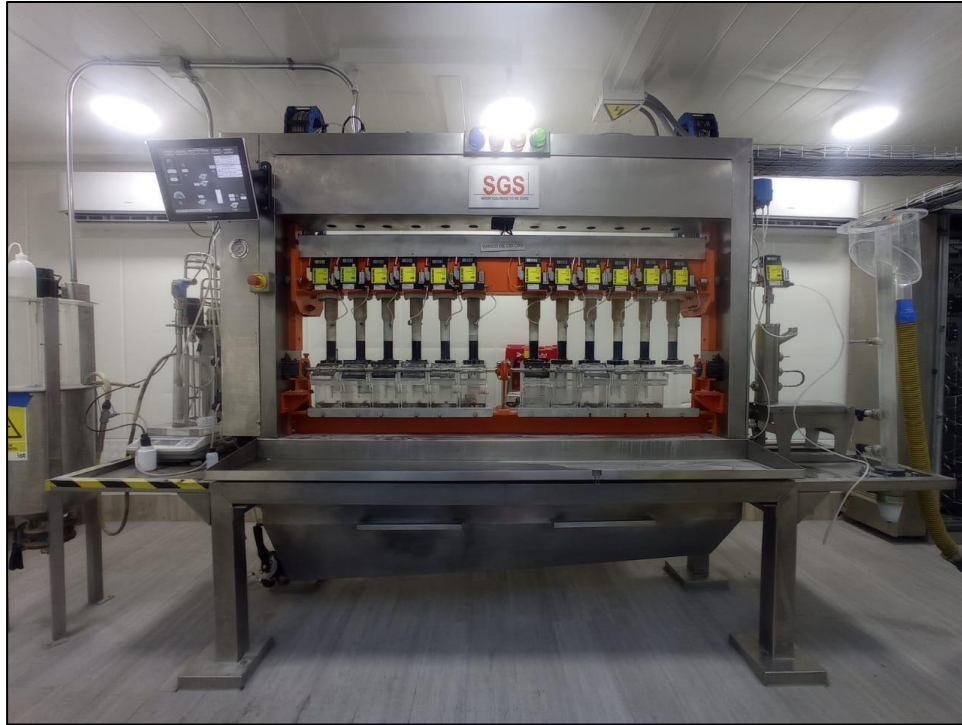
Ilustración 5.6: Banco de celdas - Máquina de flotación continua
