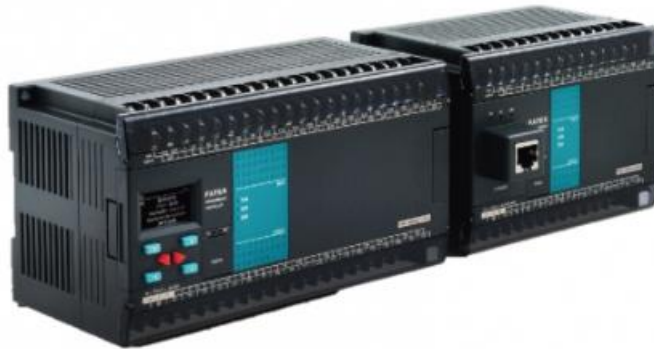
Ilustración 0.11: Estructura externa PLC marca Fatek. Fuente: www.fatek.com
