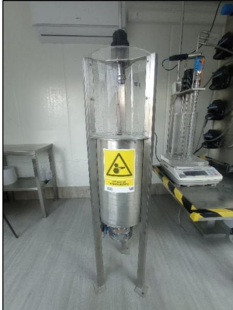
Ilustración 5.2: Tanque agitador o "Holding Tank"
