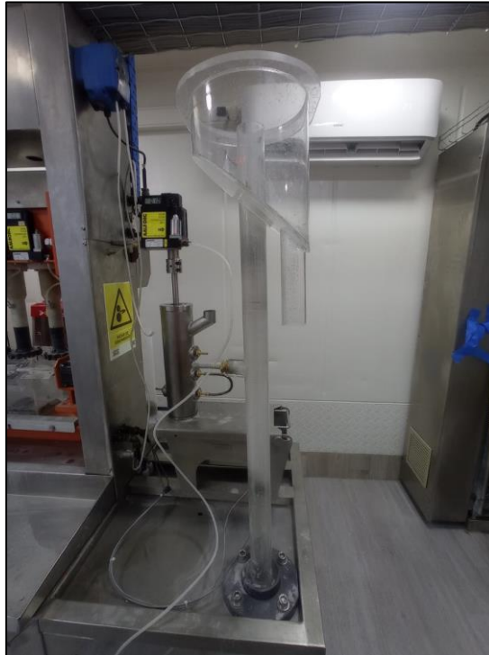
Ilustración 5.11: Columna de flotación - Vista frontal
