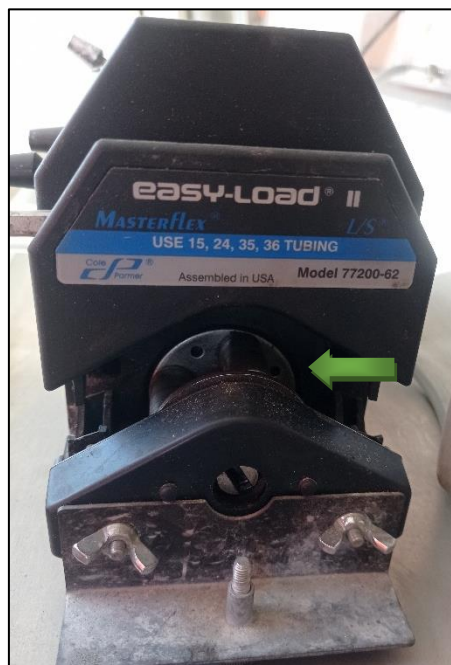
Ilustración 5.20: Cabezal de bomba peristáltica - Vista de rodamientos interiores
