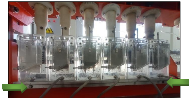
Ilustración 5.14: Celdas de flotación - Vista posterior
