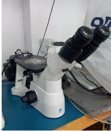
Figura 3.18 "Microscopio metalográfico" Fuente: Elaboración propia.
