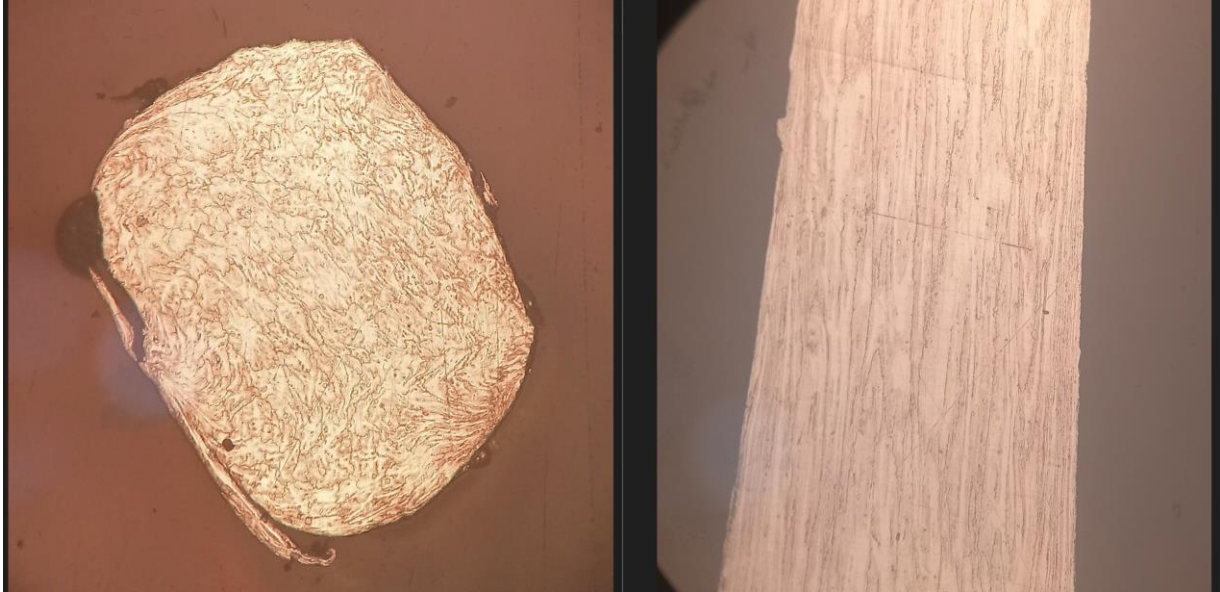
Figura 4.23 "Tocho 2 laminado en frío"
