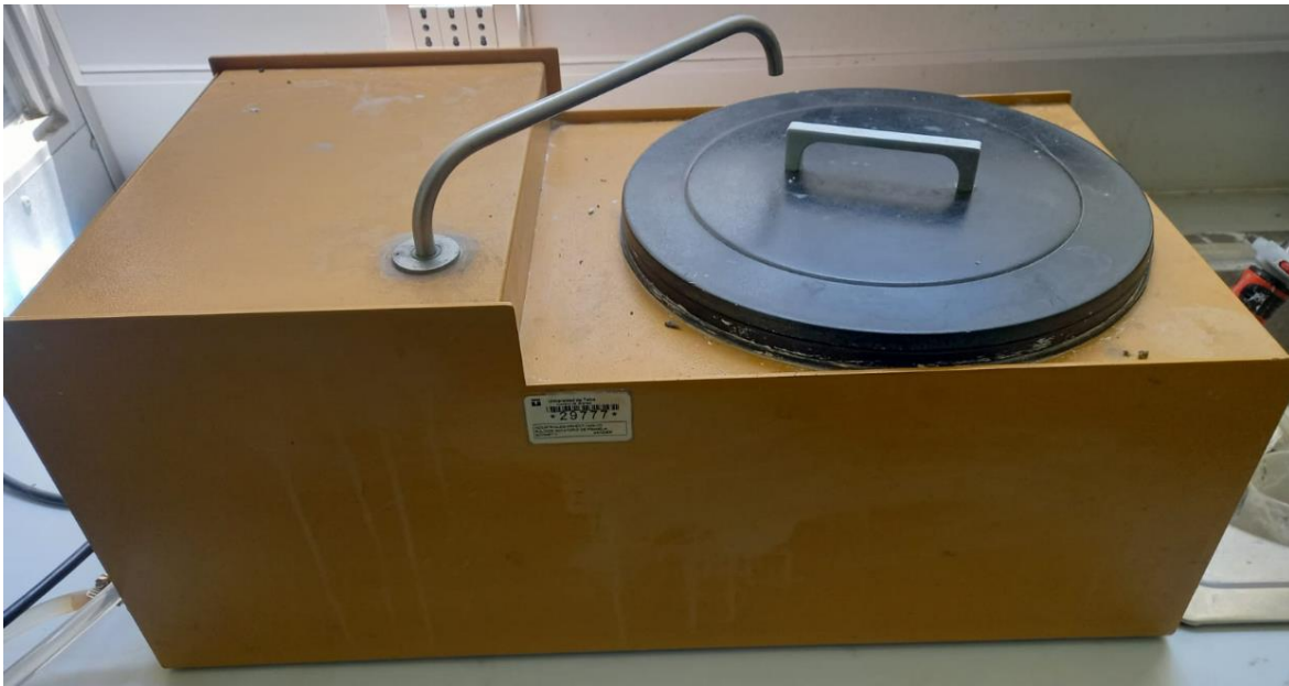
Figura 3.14 "Pulidora Ecomet II Grinder" Fuente: Elaboración propia.
