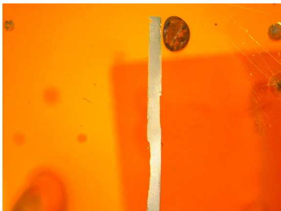
Figura 4.9 “Tocho 1 paso 9 laminación en frío(a) y caliente(b) con aumento de x8”
