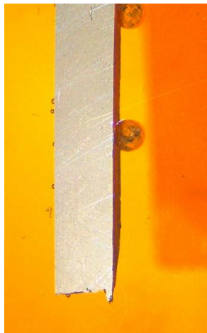
Figura 4.6 “Tocho 1 paso 6 laminación en frío(a) y caliente(b) con aumento de x8”
