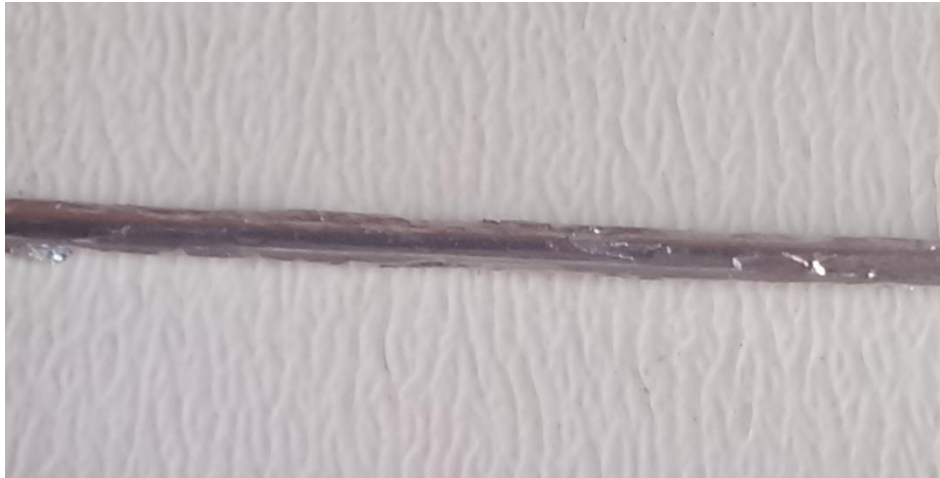
Figura 3.11 "Alambre con incrustaciones de rebaba" Fuente: Elaboración propia.
