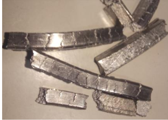
Figura 3.7 "Fracturas paso 1 prueba 1-1 de un material de 5,75x5,75mm" fuente: Elaboración propia.
