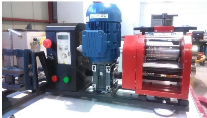
Figura 3.3 "Laminadora Roll-forming" Fuente: Elaboración propia.
