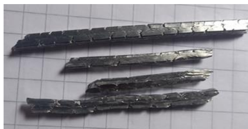
Figura 5.15 “Agrietamiento y fracturas del material prueba 3-4” Fuente: Elaboración propia
