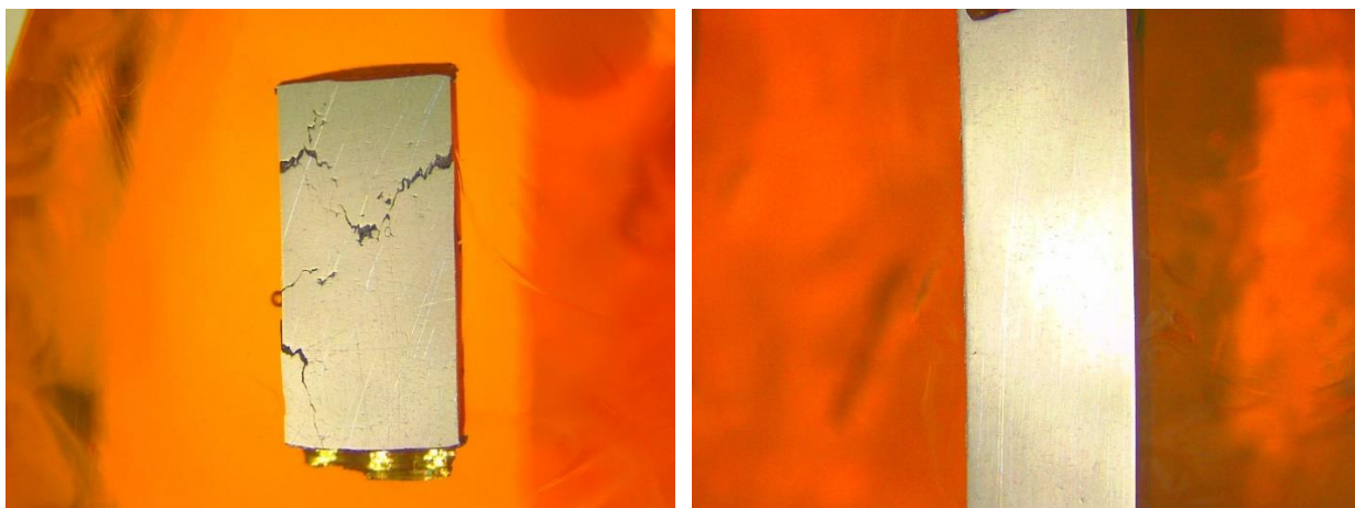
Figura 4.3 “Tocho 1 paso 3 laminación en frío(a) y caliente(b) con aumento de x8”
