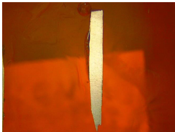
Figura 4.9 “Tocho 1 paso 9 laminación en frío(a) y caliente(b) con aumento de x8”
