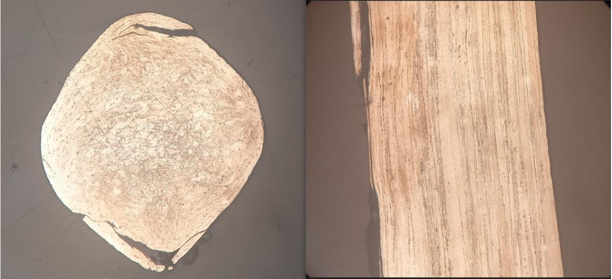
Figura 4.24 "Tocho 2 laminado en frío"
