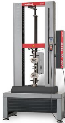
Figura 3.19 "Maquina de traccion Zwick/ Roell Z005" Fuente: Zwickroell.com
