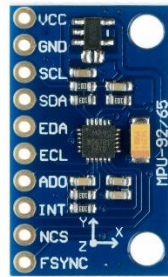
Fig. 4.8 placa IMU 9250 10 axis.
