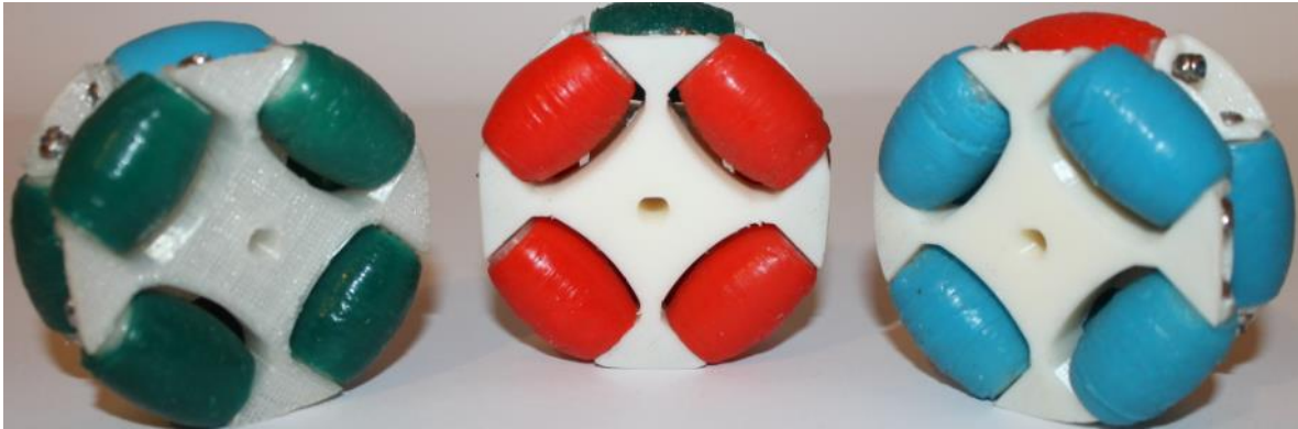
Fig. 4.2 Ruedas omnidireccionales del ballbot UT.
