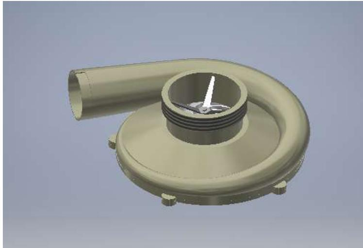
*Figura 24. Ensamble del rotor de succión y de la cápsula.*
