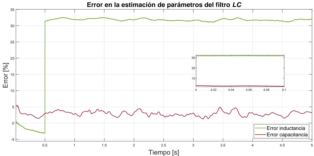
Fig. 5.67: Error en estimación de parámetros del filtro  $LC$  ante cambio escalón de 150% en valor de inductancia con carga no lineal.
