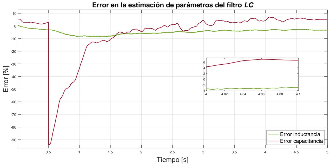
Fig. 5.63: Error en estimación de parámetros del filtro  $LC$  ante cambio escalón de 50% en valor de capacitancia con carga no lineal.
