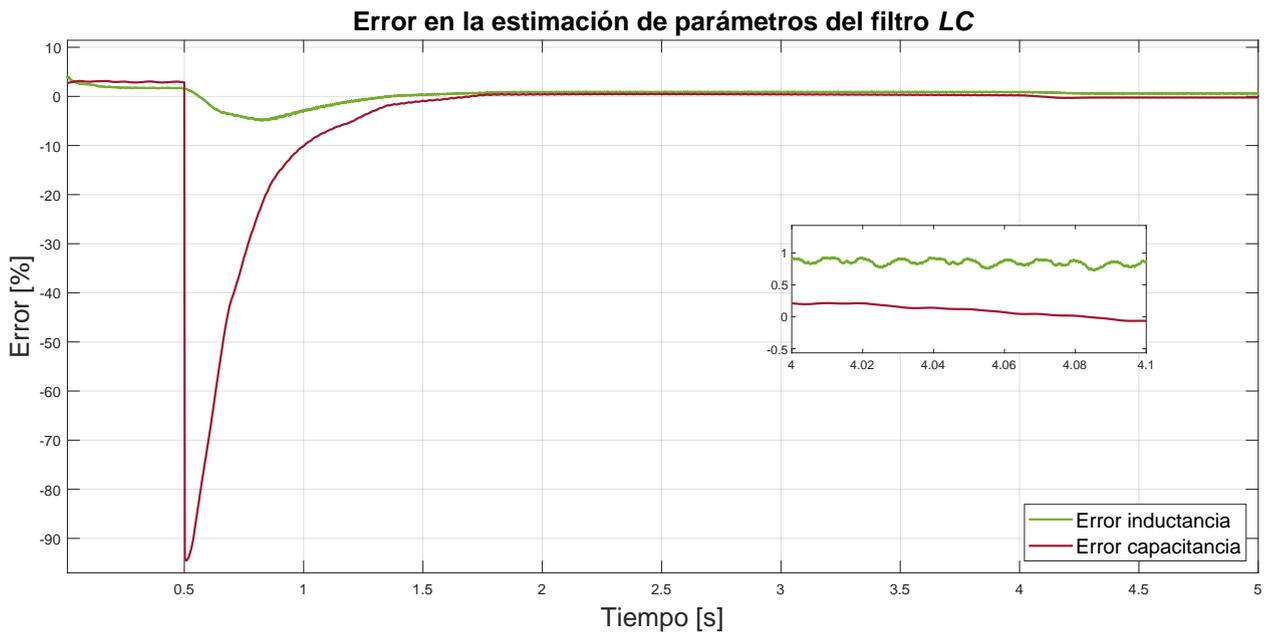
Fig. 5.48: Error en estimación de parámetros del filtro  $LC$  ante cambio escalón de 50 % en valor de capacitancia con carga lineal.
