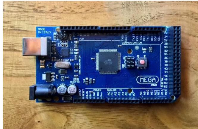
Fig. 2.5 Arduino Mega 2560 utilizado para el control del Drone.
