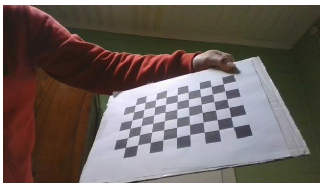
Fig. 3.19 Imagen del tablero de ajedrez y una de las imágenes utilizadas para la calibración de la cámara.
