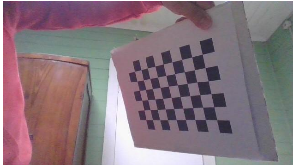
Fig. 3.15 Imagen del tablero de ajedrez y una de las imágenes utilizadas para la calibración de la cámara.
