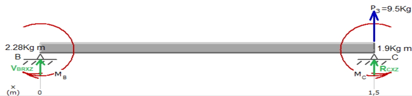
Fig. 2.15 Diagrama cuerpo libre tramo BC plano XZ MDSolids.
