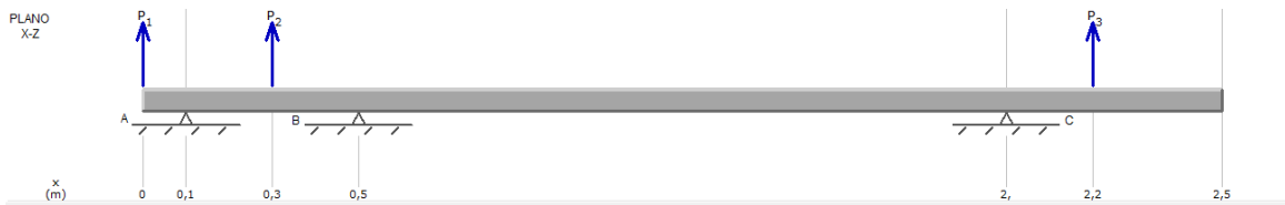
Fig. 2.12 Diagrama cuerpo libre plano XZ MDSolids.
