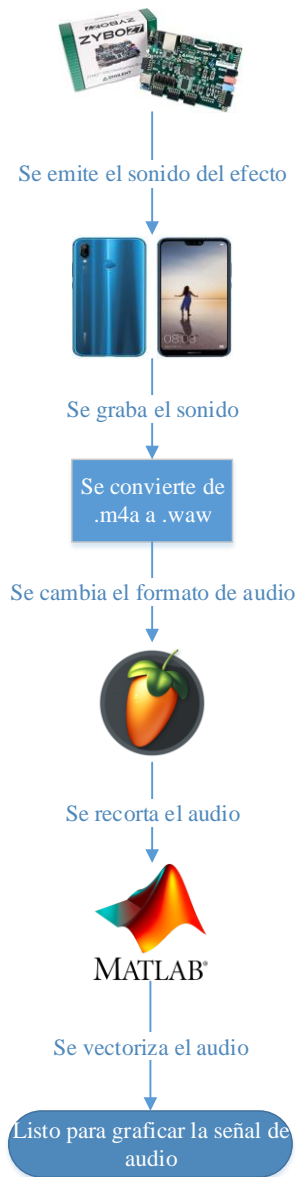
Fig.5.1. Diagrama de grabación y post tratamiento del audio.
