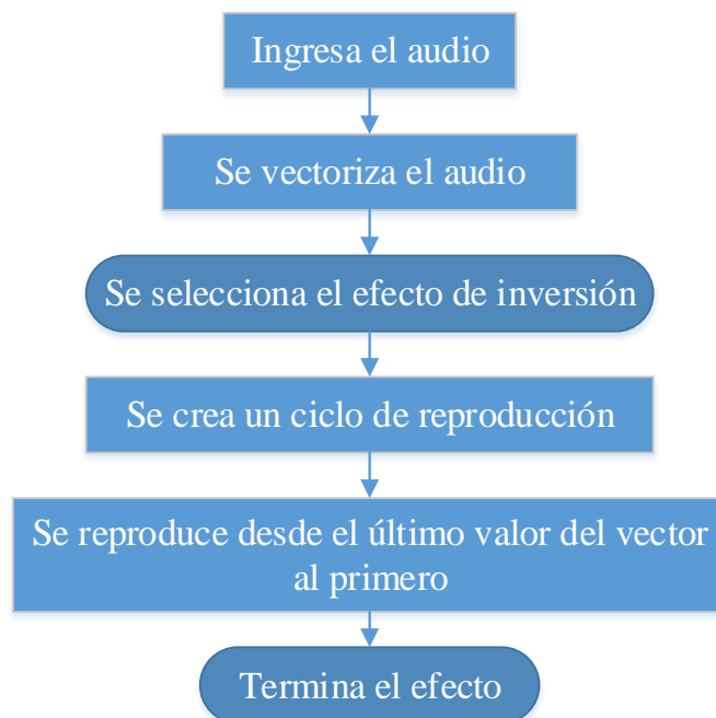
Fig.3.15. Diagrama de flujo del efecto 3.
