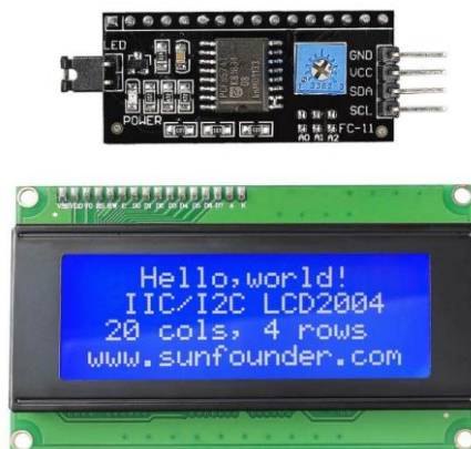
Fig.4.6. Modelo físico pantalla LCD module 2004 más comunicador I 2 C[55].
