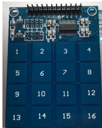
Fig.4.2. Tarjeta física teclado táctil 8/16 teclas TTP229-BSF.
