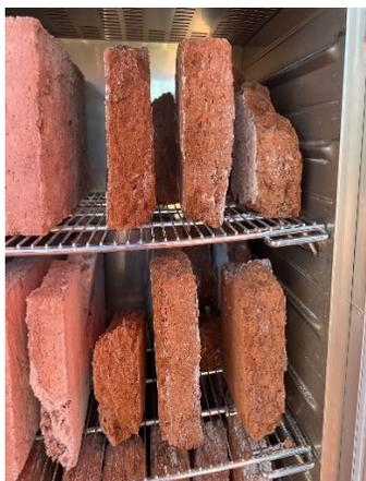
*Imagen 22. Cocción de ladrillos dosificación 2 y 3 a 200°C.*
