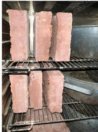
*Imagen 21. Cocción de ladrillos dosificación 1 a 200°C.*
