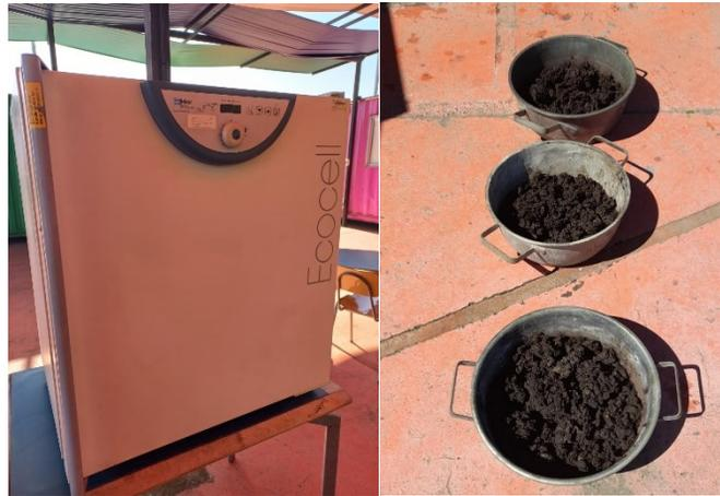
*Imagen 12. Secado del lodo en horno - Lodo seco.*
