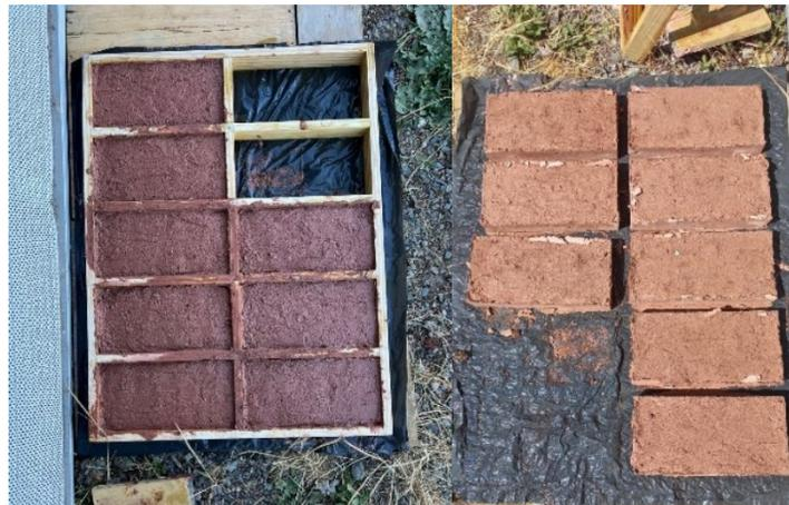
*Imagen 18. Ladrillos de cal y 10% de lodo.*
