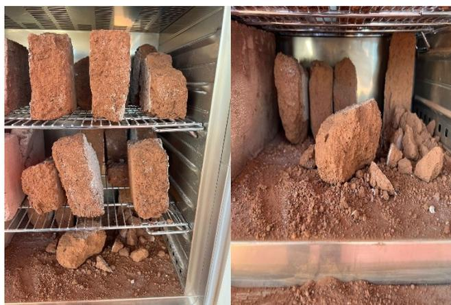
*Imagen 24. Ladrillos dosificación 2 y 3 al ser sacados del horno.*
