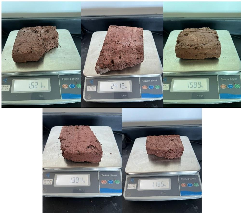
*Imagen 27. Masa de ladrillos saturados.*
