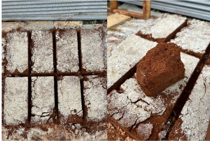
*Imagen 20. Ladrillos de 5% y 10% de lodo, dosificación 2 y 3.*
