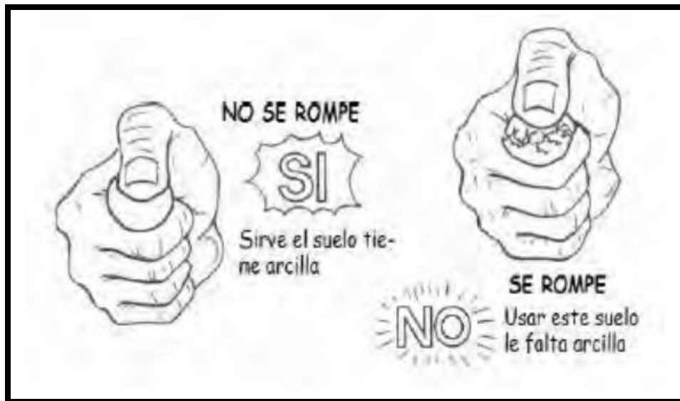
Ilustración 12: “Prueba de presencia de arcilla o resistencia seca” Fuente: Libro: “Uso del tapial en la Construcción, 2019”.
