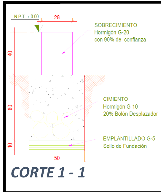
Ilustración 30: “Corte de fundación” Fuente: Elaboración propia.
