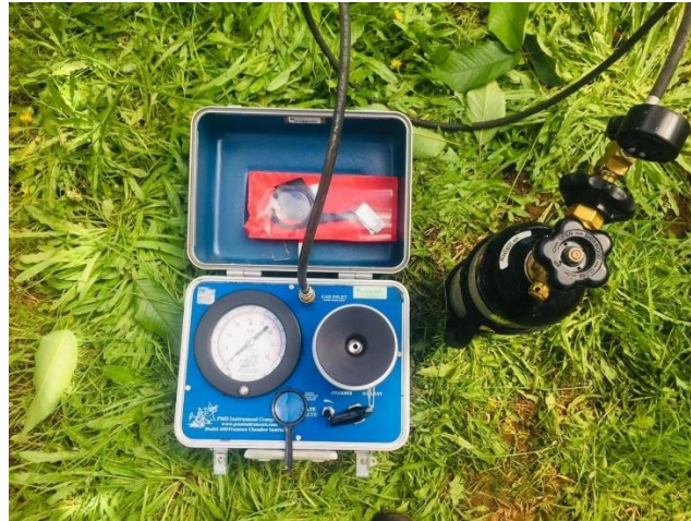
Figura 4. Utilización de cámara de presión tipo Scholander para obtención de variable de estado hídrico.
