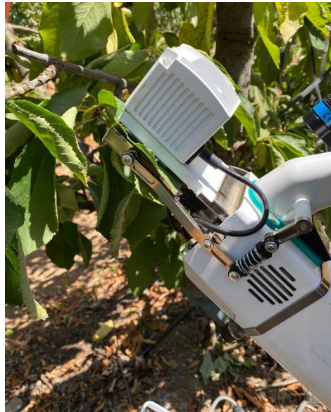
Figura 3. Medición del intercambio gaseoso en hojas de Cerezo con instrumento LI-6800 Portable Photosynthesis System (LI-COR).
