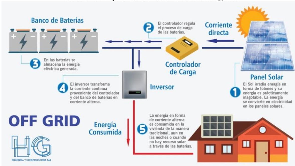
Ilustración 6: Componentes de un sistema fotovoltaico Off Grid
