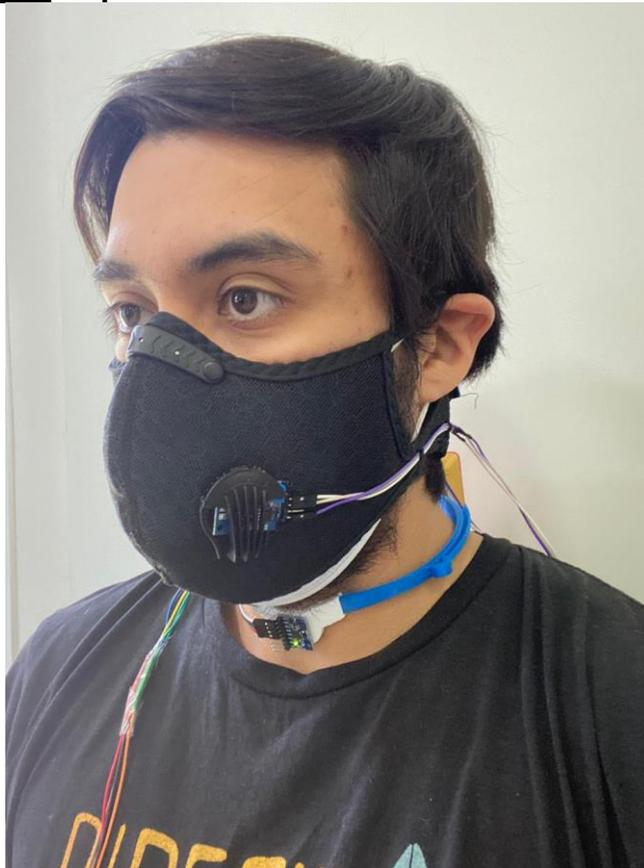
**2.6.2 Ilustración 3:** Vista del sensor de Frecuencia respiratoria y Concentración de CO<sub>2</sub>.
