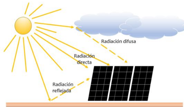
Figura 1: Diagrama de los tipos de radiaciones que inciden en un sistema fotovoltaico. Fuente: Alonso (s.f.)
