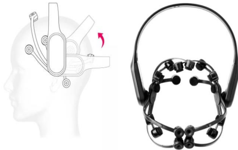
Figura 10: Ilustración de un Brainwear. Es un hardware el cual tiene electrodos para hacer análisis de los impulsos nerviosos. Tomado de EMOTIV (2021)
