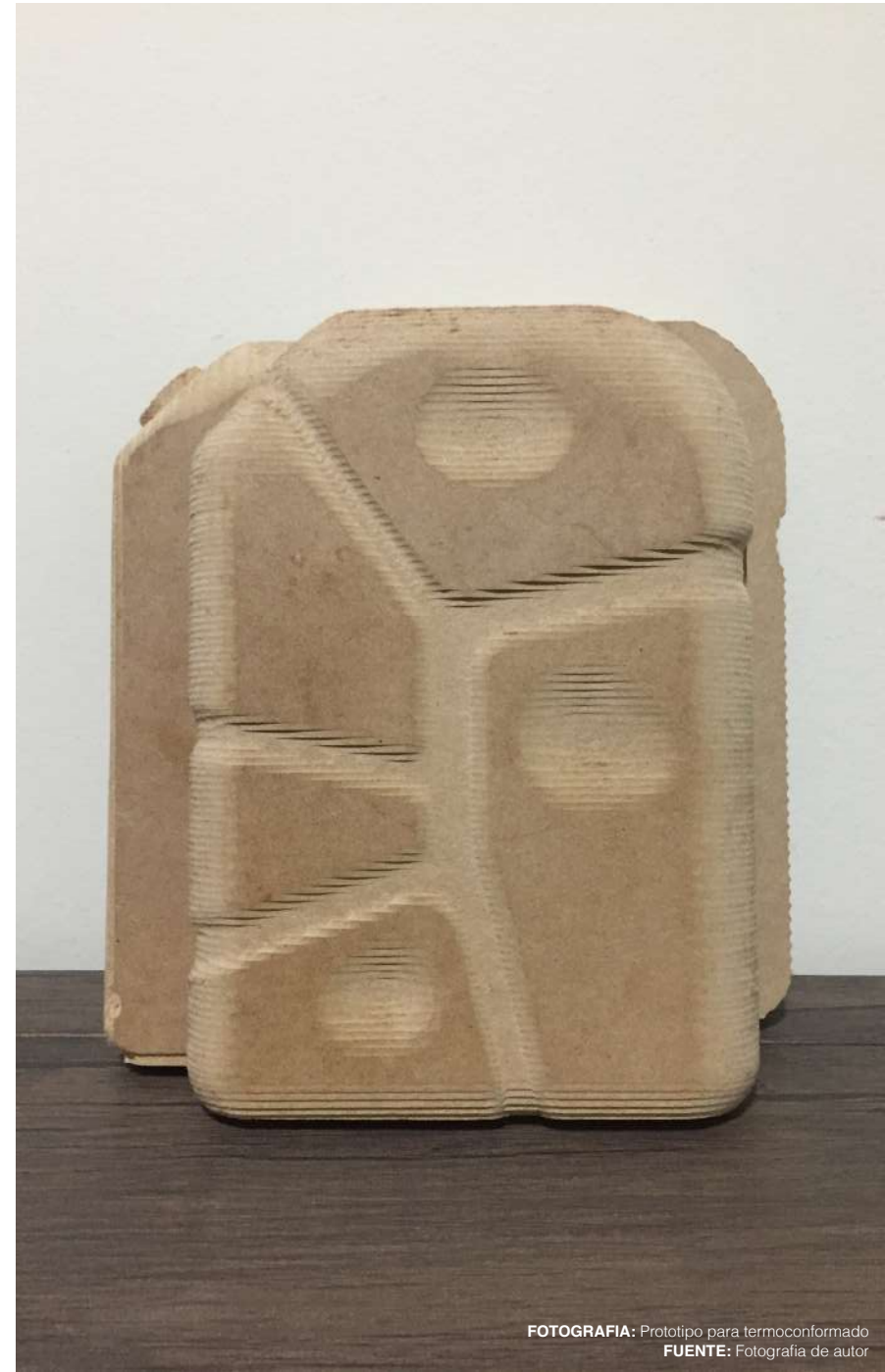
FOTOGRAFIA: Corte de relieve cnc. Prototipo para termoconformado FUENTE: Fotografía de autor
