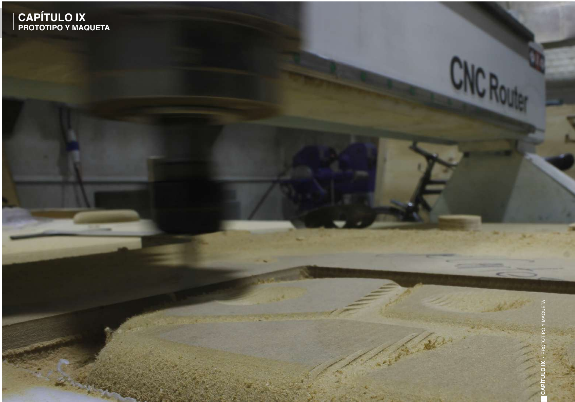
FOTOGRAFIA: Prototipo para termoconformado (corte de relieve cnc) FUENTE: Fotografía de autor
