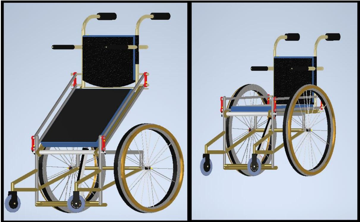
*Ilustración 30. Diseño 3D Silla de ruedas con elevación de 70 grados (izquierda) y en estado normal (derecha). Fuente: Elaboración propia.*
