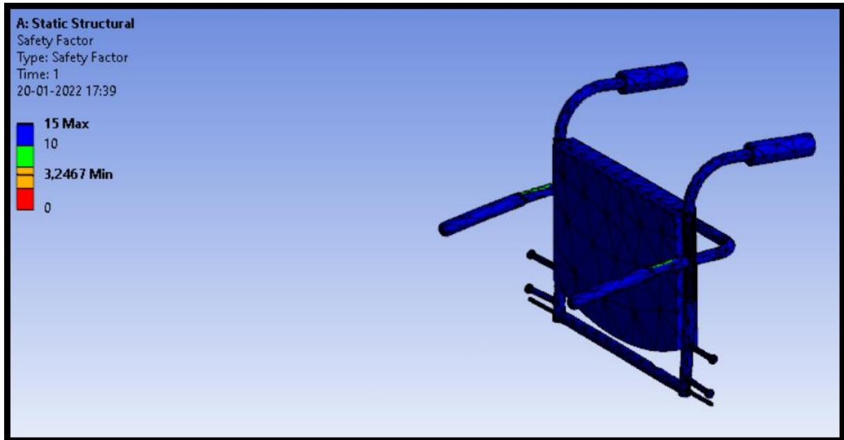
*Ilustración 69. Factor de seguridad en el respaldo. Fuente: Elaboración propia.*
