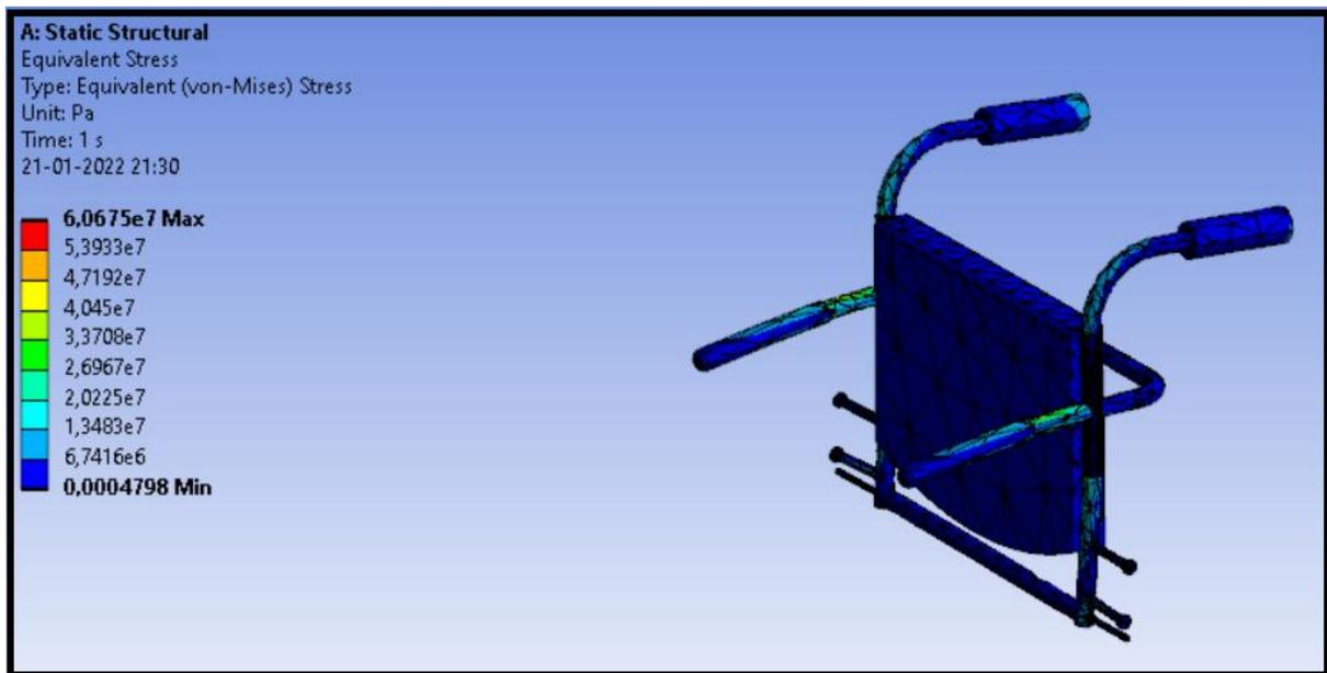
*Ilustración 68. Esfuerzo De Von Misses en el respaldo por simulación computacional. Fuente: Elaboración propia*
