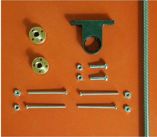
Ilustración 33: piezas necesarias para el ensamble del tornillo de potencia (fuente: elaboración propia).
