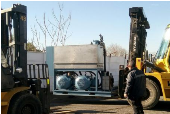
Ilustración 8: Mesa sísmica de la USACH. Fuente: USACH.
