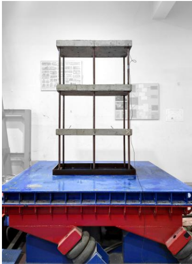
Ilustración 7: Modelo a escala sobre mesa sísmica. Fuente: Universidad Politécnica de Madrid.
