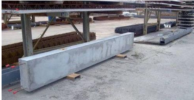
Ilustración 9: Viga fabricada, lista para ser instalada en obra.
