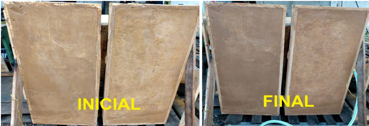
Ilustración 36: Comparación talud 90° segundo ensayo.
