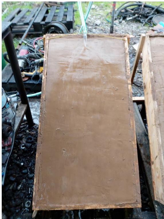
Ilustración 30: Esquema de ensayo escurrimiento.
