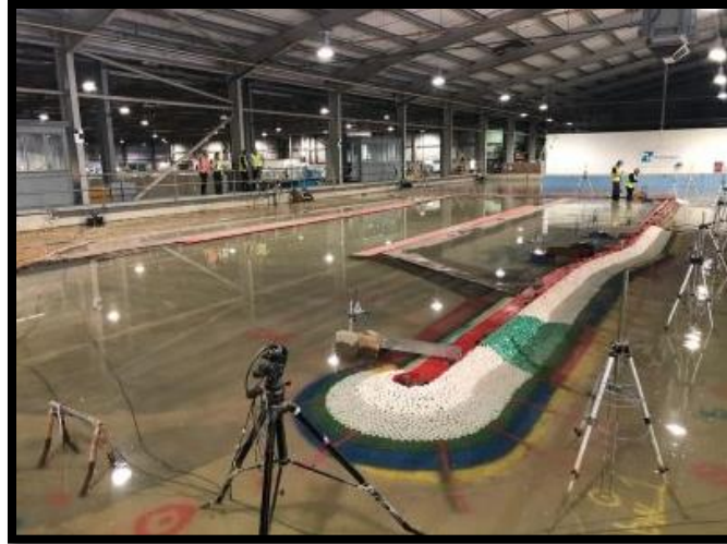
Ilustración 32: Pruebas de laboratorio para rompeolas del puerto exterior de San Antonio
