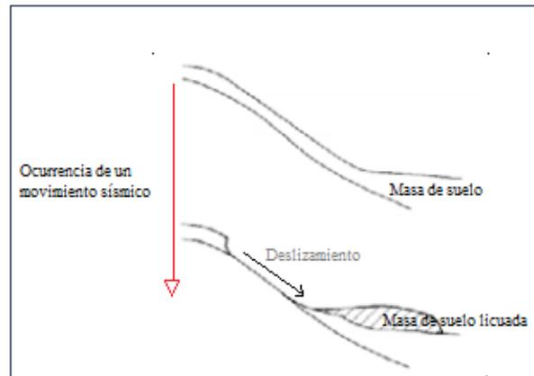
*Ilustración 23: Diagrama de la falla de flujo causada por el fenómeno de licuación*
