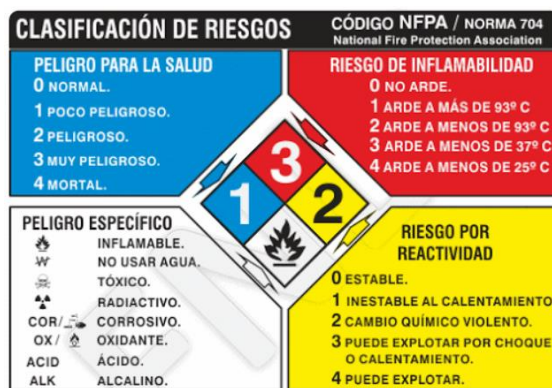
Ilustración 2.4 Clasificación de riesgos según NFPA. Fuente: NFPA
