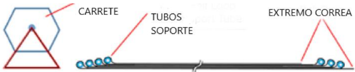
Figura 2.13 El boceto muestra el diseño de la pila de correas dobladas, con un carrete contenedor y soporte de descarga en el extremo izquierdo.
