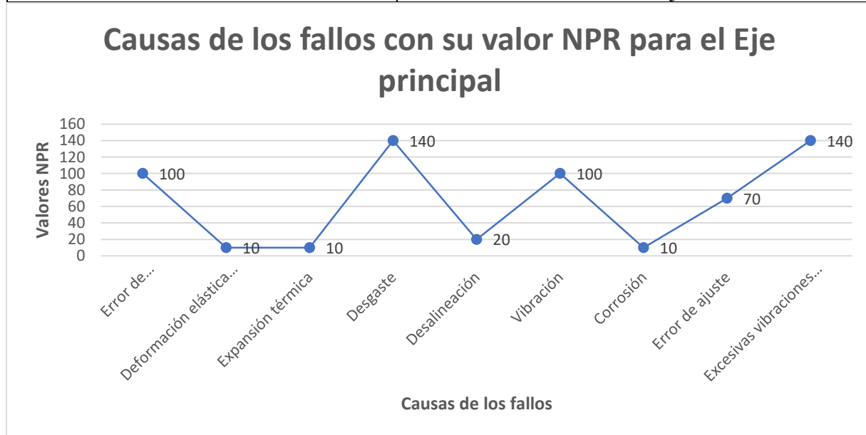
Gráfico 4-9: Causas de los fallos con su valor NPR para eje principal. Fuente: Elaboración propia
