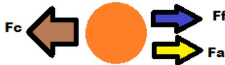
*Ilustración 2.3 Diagrama cuerpo libre cuando las partículas están sometidas a los efectos de un campo centrífugo. (Elaboración propia).*
