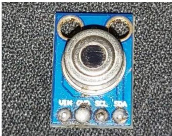
*Figura 3-8 Módulo sensor de temperatura*
