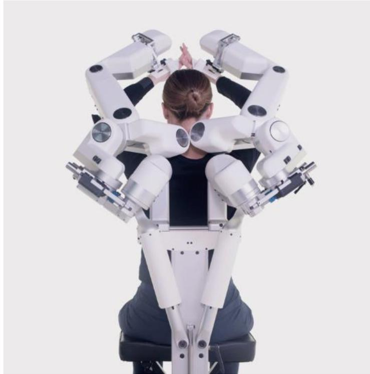
*Figura 2-6 Exoesqueleto robótico de rehabilitación de extremidades superiores*
