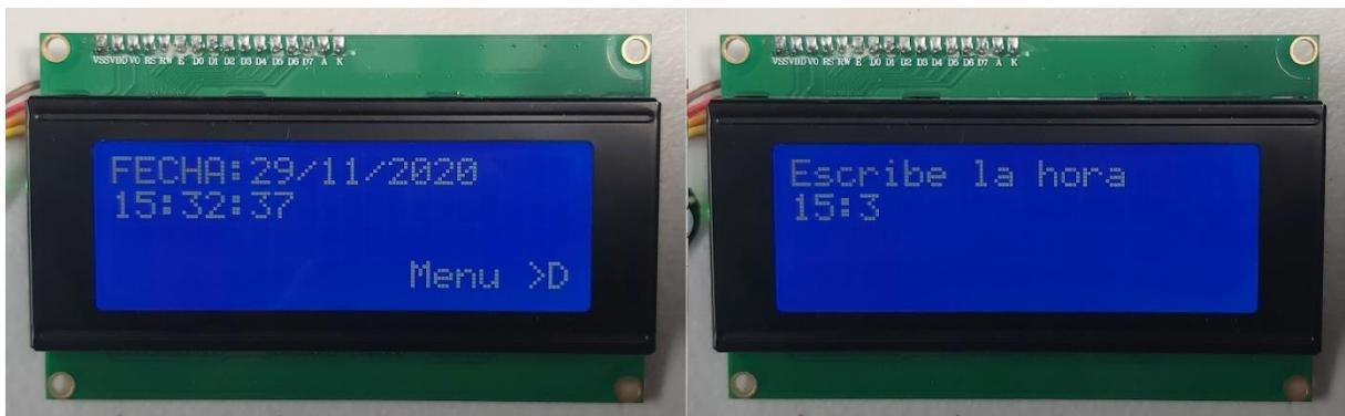
*Figura 6-2 Menú Reloj. Fecha y Hora (Izq) Configuración de Alarma (Der)*
