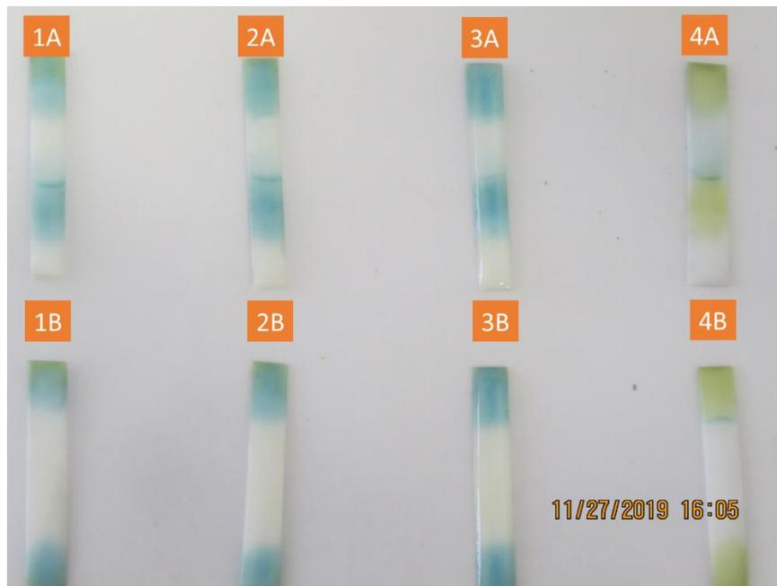
*Imagen 22 Cambio de color en parejas de tiras reactivas, producto de la difusión de la orina. Volúmenes de muestra de 30, 60, 120  $\mu$ l y control con agua bidestilada. Fuente propia.*
