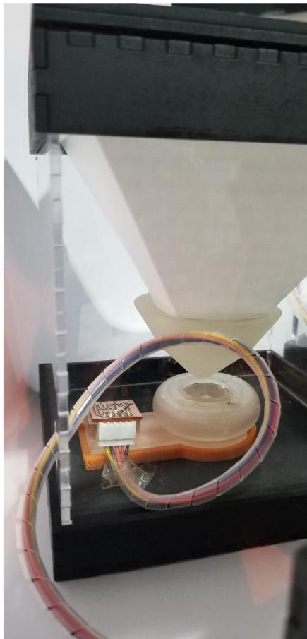
*Imagen 119 Close-up segundo nivel: Separación y colección de muestra. Fuente propia.*
