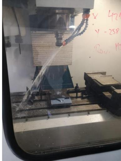
*Imagen 76 Proceso de mecanizado de material base en el equipo. Fuente propia.*
