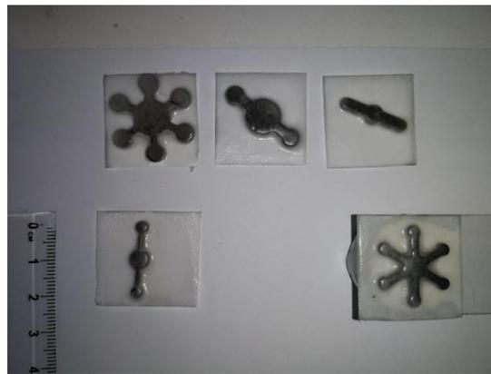
*Imagen 35 Cinco de las seis geometrías enfriándose para luego retirar el molde de metal correspondiente. Fuente propia.*
