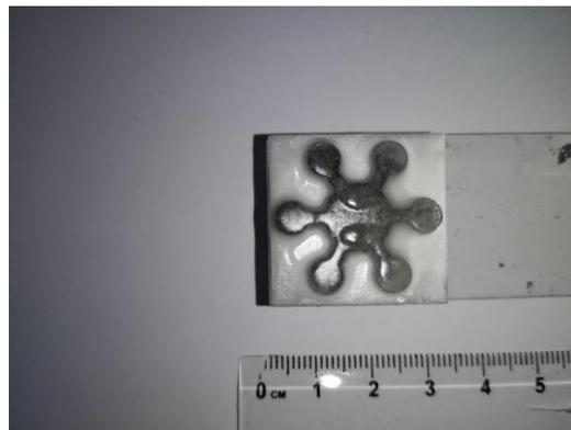
*Imagen 33 Vista superior del sistema acoplado luego de ser sumergido en parafina derretida. Fuente propia.*
