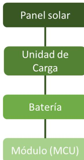
*Imagen 61 Esquema de alimentación para el prototipo 2. Fuente propia.*
