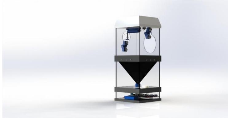
Imagen 52 Vista isométrica del diseño del prototipo 2. Fuente propia.
