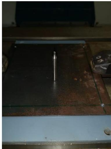
*Imagen 77 Broca de fresa de 2mm, utilizada para mecanizar el material. Fuente propia.*
