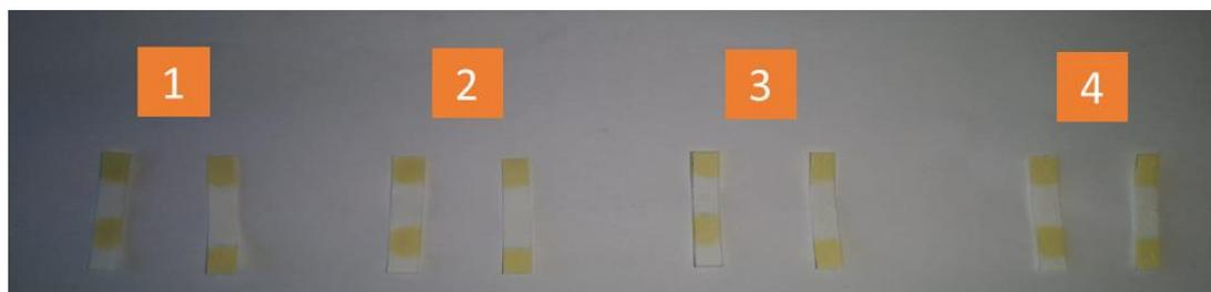
*Imagen 21 Parejas de tiras reactivas impregnadas con verde de bromocresol y albúmina de suero bovino, según las configuraciones A y B. Fuente propia.*
