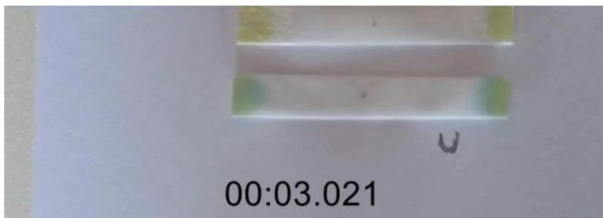
*Imagen 67 Situación experimental detección de albúmina en muestra de orina, a los 3 segundos.
