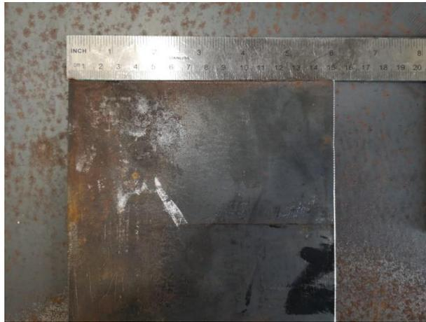
*Imagen 72 Trozo de 15x15 cm de plancha laminada acero A36 de 2 mm de espesor. Fuente propia.*
