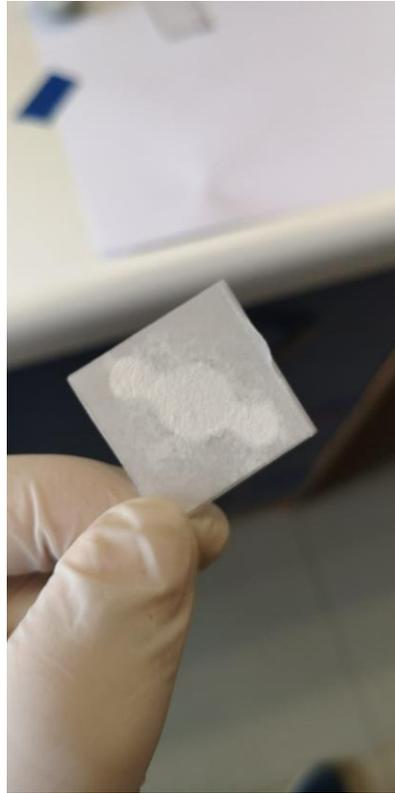
*Imagen 36 Dispositivo microfluídico donde al interior de la geometría se tiene la zona hidrofílica y al exterior la zona hidrofóbica. Fuente propia.*
