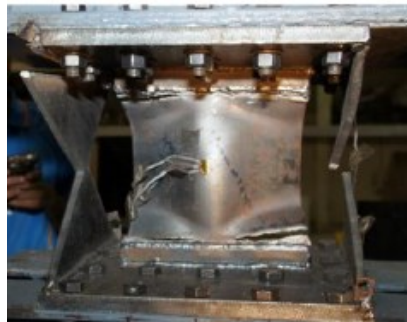
Figura 2.13: Disipador SAFYD luego de un ensayo de falla. Fuente: Sahoo et al., 2015.
