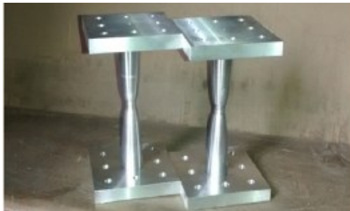
Figura 2.8: Disipador HADAS. Fuente: Basu & Reddy, 2016.
