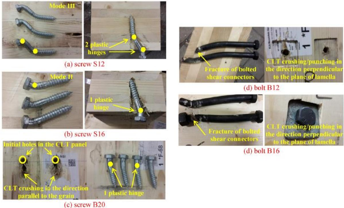
Figura 28 (a) Modo de fallo de las uniones compuestas de acero-CLT con (a) Tornillo 12 mm, (b) Tornillo 16 mm (c) Tornillo 20 mm (d) Perno 12 mm y 16 mm.
