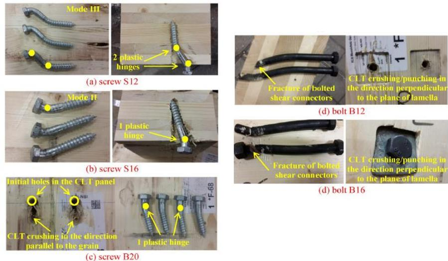
El uso de placas de refuerzo no alteró el modo de falla de las uniones con tornillos, pero redujeron ligeramente la ductilidad de las uniones. Este modo se asoció a la rotura de la placa, al aplastamiento localizado de la madera y la formación de una o dos deformaciones plásticas en los tornillos, dependiendo del diámetro de estos (figura superior). Las uniones
