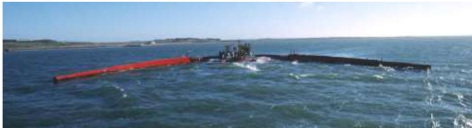
FIGURA 2.10 Wave Dragon dispositivo de 7 MW, Dinamarca. (Errazuriz y asociados, 2012)
