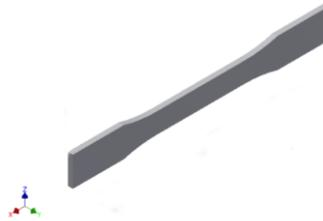
*Ilustración 20: Probeta para ensayo en Tensión [19]*
