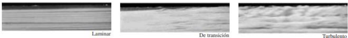
Figura 2.1: Fotografía de flujo laminar, de transición y turbulento. (1)
