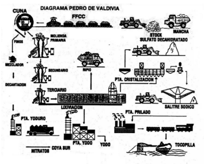
Figura 2.8: Diagrama de procesos de la planta Pedro de Valdivia. Fuente: (Franzosi & Montagna, 2007)
