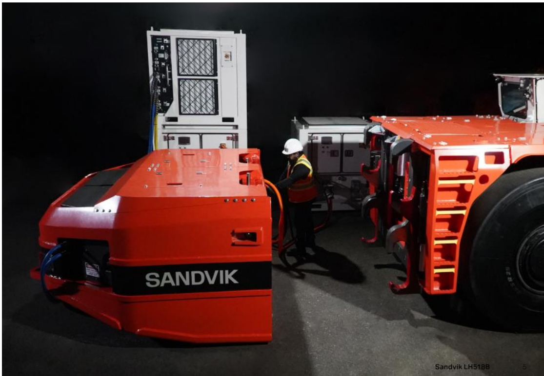
Ilustración 15: Imagen LHD modelo LH518B de SANDVIK, con batería desmontada y en estación de recarga (SANDVIK, 2021d)
