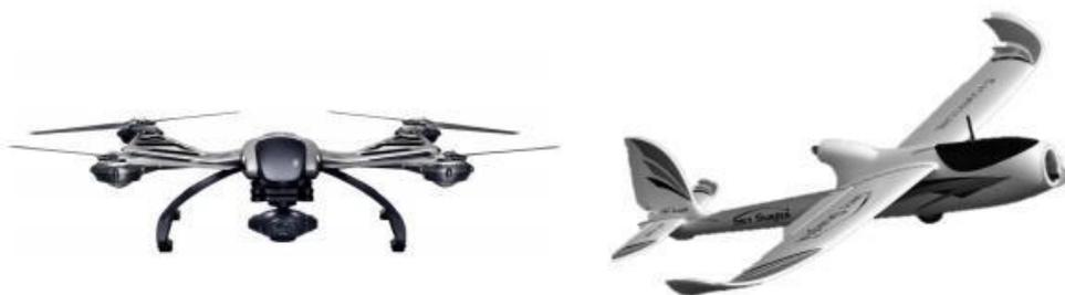
**Figura1.** Dron multirrotor (cuadricóptero) y Dron de ala fija. (Pino, 2019).
