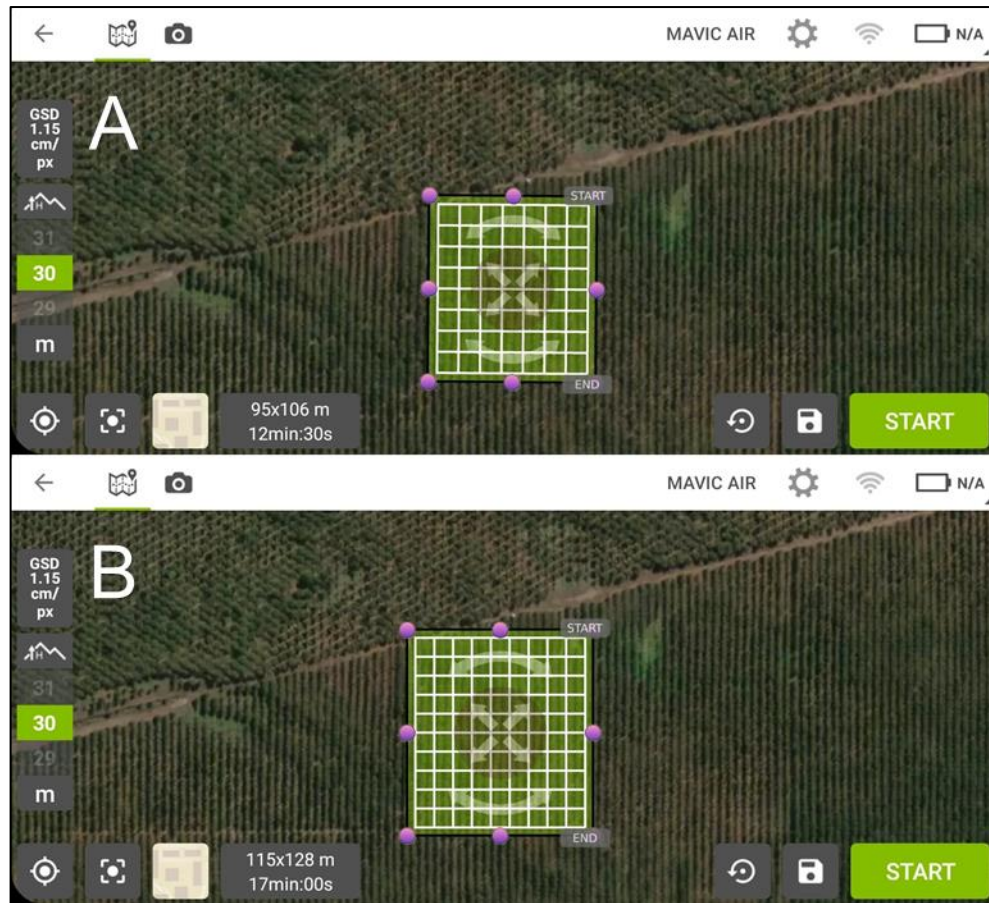
Figura 3.2. Elaboración de grilla doble con el software Pix4Dcapture en el sitio experimental. A. Grilla para la temporada 2019-2020. B. Grilla para la temporada 2020-2021.
