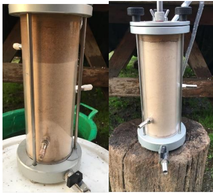
Figura 4.7: Ensayo de permeabilidad.
