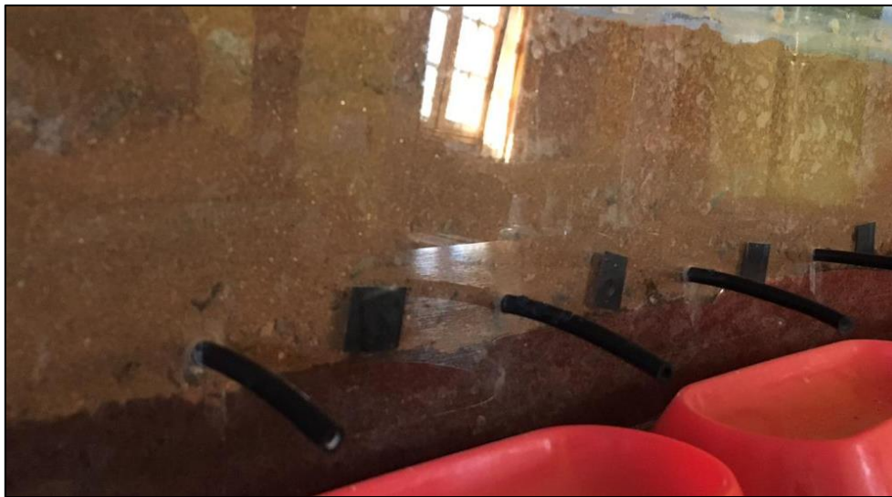
Figura 4.33: Representación con distancia de 10 cm entre tuberías.
