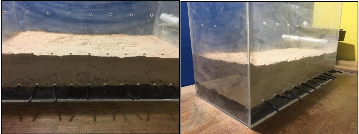
Figura 4.26: Armado final del Botadero de Rípios.
