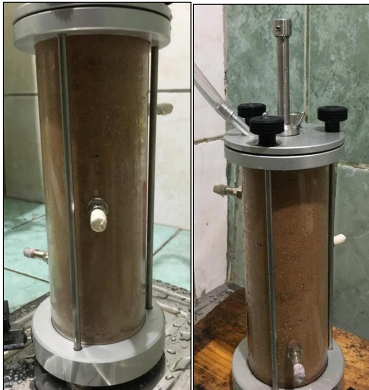
Figura 7.3: Ensayo de permeámetro con suelo Saturado.
