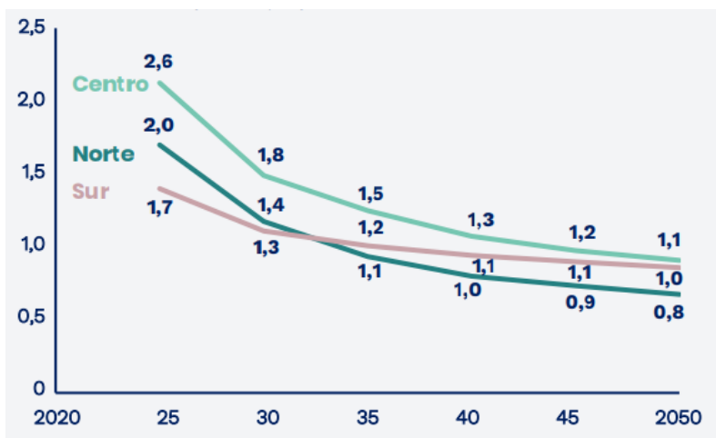
Figura 3.10: Costo nivelado de hidrógeno verde (USD/kg H 2 ).
