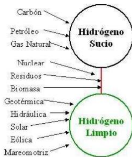
Figura 3.3: Clasificación del hidrógeno en hidrógeno limpio y sucio.
