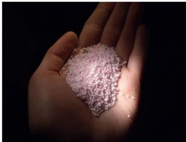
Figura 3.1: Perlas de ANFO (Mezcla de Nitrato de Amonio y petróleo).
