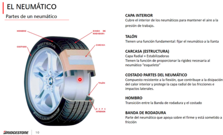
Figura 2.1: Partes que componen a un neumático ( Bridgestone ).
