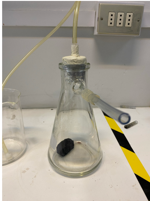
Figura B.10: Fotografía de un trozo de neumático siendo sometido a una ozonificación intermitente.
