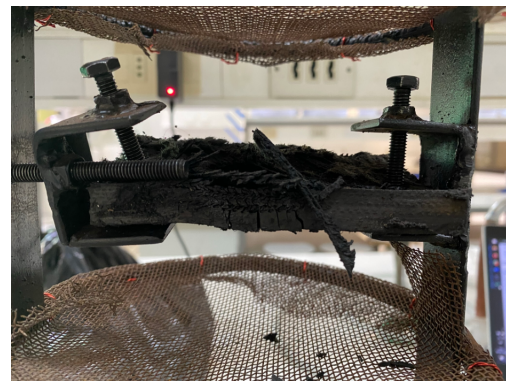
(b) Muestra 28, fracturamiento al 43 %.
