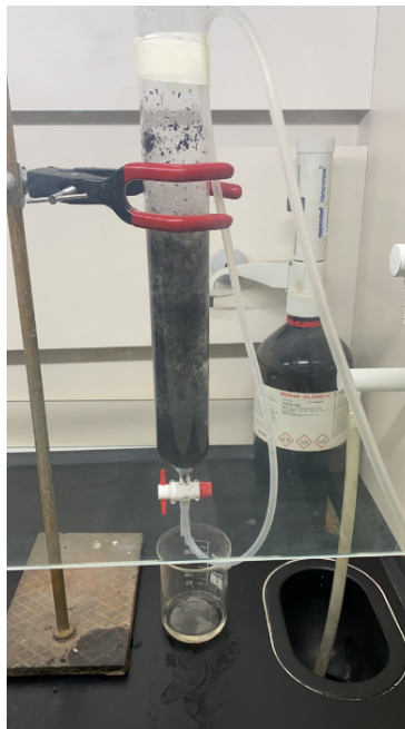
Figura B.11: Fotografía de un trozo de neumático siendo sometido a una inyección constante de ozono en un ambiente líquido de agua destilada.
