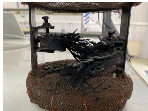
(d) Muestra 31, fracturamiento al 100 %.
