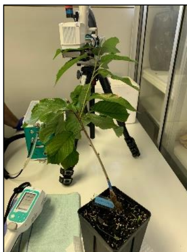
Figura 3.5. Utilización de instrumento LI-6800 Portable Photosynthesis System (LI-COR) para obtención de las variables fisiológicas de planta.
