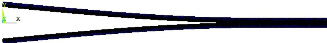
Figura 4.3: Desplazamiento de la probeta y propagación de la grieta mediante el X-FEM
