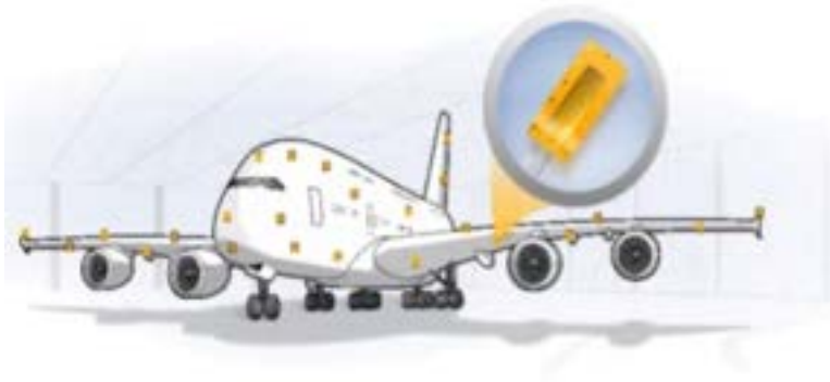
Figura 1.5: Pruebas con galgas extensométricas en análisis de tensión residual [7].
