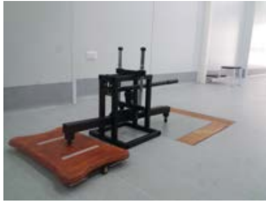
Figura 3.6: Proceso de toma de muestras con la máquina que aplica presión en 2 puntos de apoyo.
