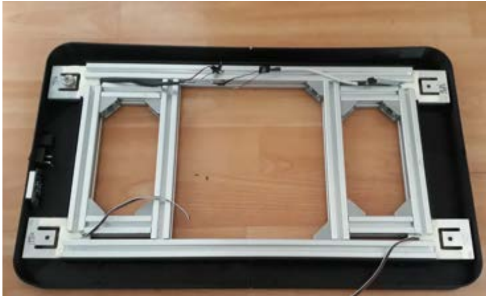
Figura 2.49: Estructura plástica unida a estructura metálica.
