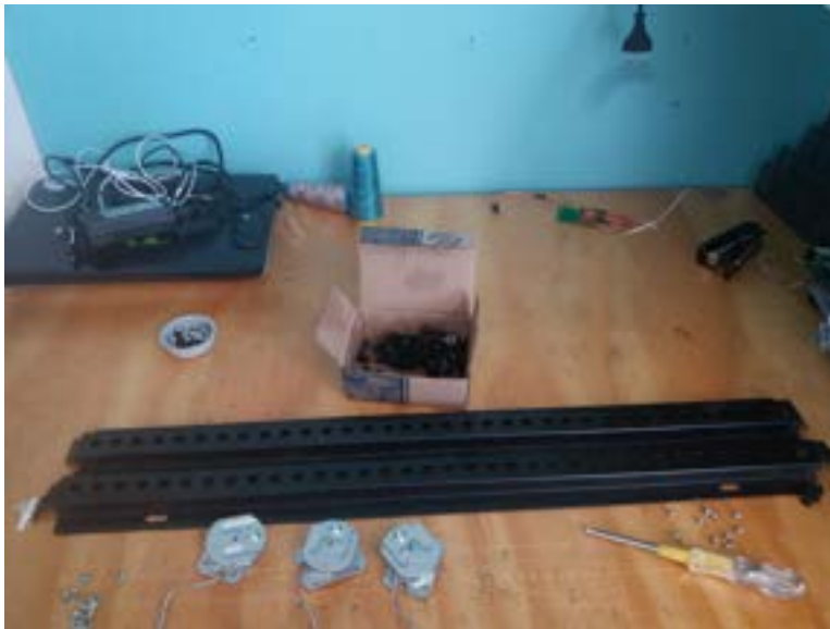
Figura 2.3: Perfiles para construcción de plataforma
