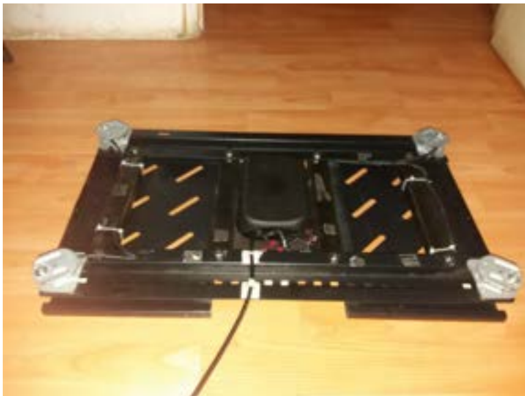
Figura 2.7: Estructura tipo plataforma, con las celdas montadas.
