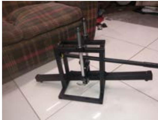
Figura 3.5: Detalle de la máquina que aplica presión en 2 puntos de apoyo terminada .
