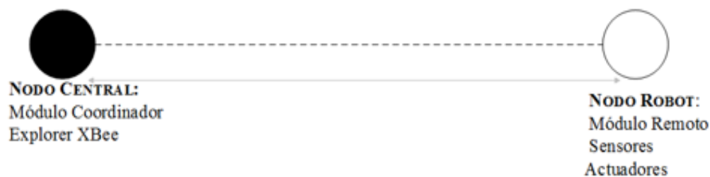
Fig. 5.2: Esquema distribución de red inalámbrica de sensores
