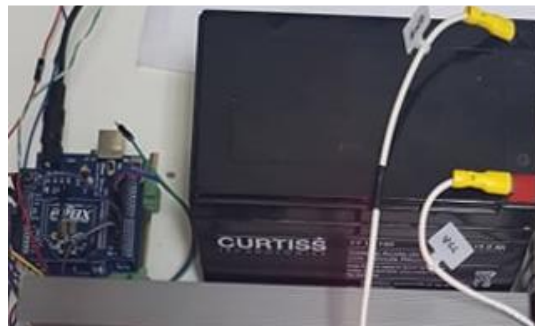
Fig.6.1: Alimentación sistema completo
