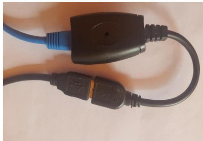
Fig.7.4: Extensión de cable mediante conversor UTP/USB.
