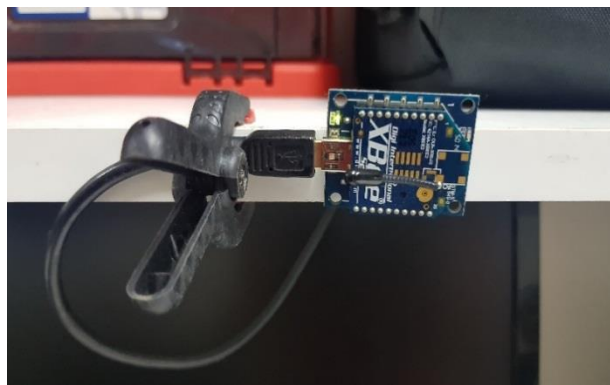
Fig.6.3: Alimentación de Nodo Central
