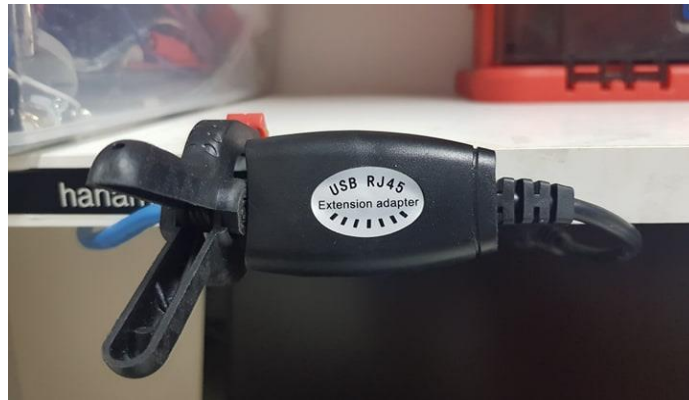
Fig.7.3 Acoplamiento de extensor USB/UTP mediante conector rj45.
